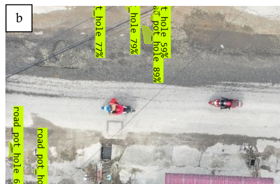
Gambar 7. Rekaman Drone dari Lokasi Penelitian di a).Jalan Delima, Pekanbaru, b).Jalan Lobak, Pekanbaru Setelah Model Deteksi Lubang Jalan Otomatis yang Dilakukan oleh YOLOv5 Diterapkan. Sumber: Pengolahan Data (Dokumentasi Pribadi)
