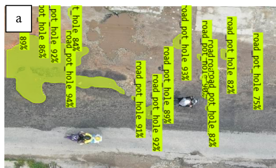
Gambar 5. Gambar Hasil Prediksi Lubang Jalan Dilakukan oleh YOLOv5. Sumber: Pengolahan Data (Dokumentasi Pribadi)
